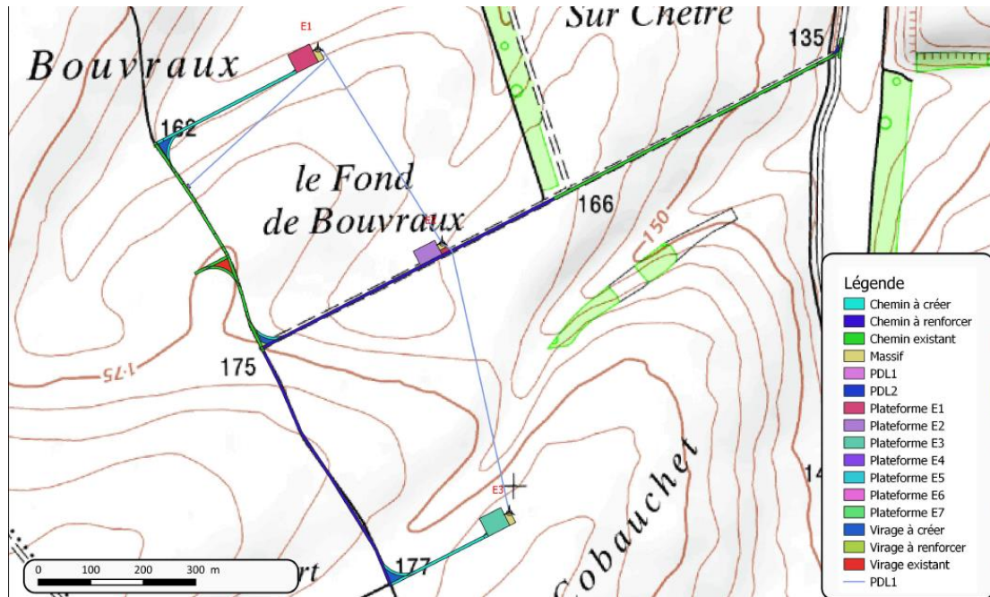
Carte 6 : Raccordement électrique (tracé bleu) du parc éolien de Bronne - Sans Souci (Eoliennes E1, E2 et E3)
