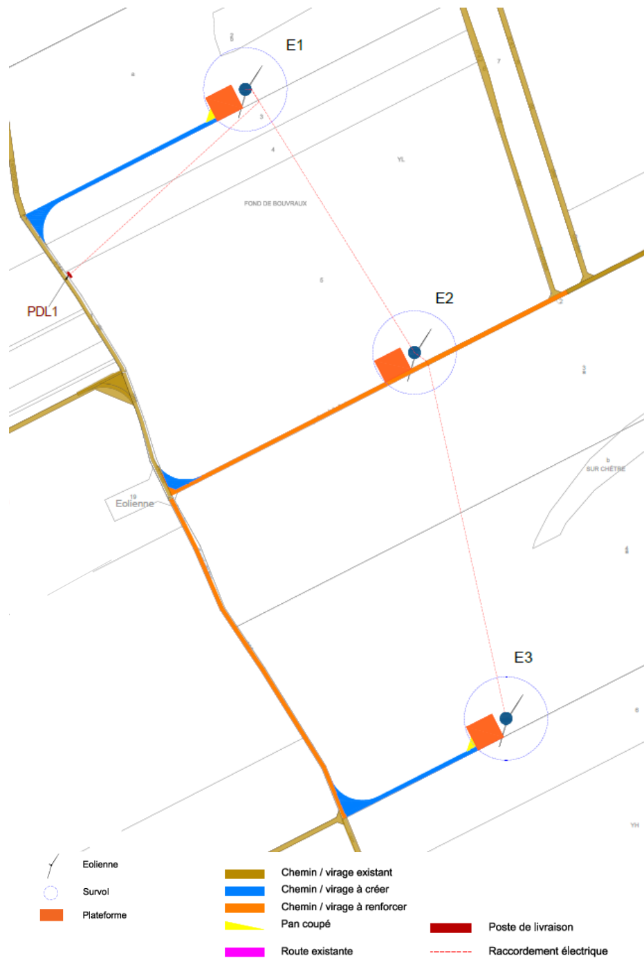
Carte 4 : Vue cadastrale du projet éolien de Bronne - Sans Souci – (Eoliennes : E1, E2 et E3 – modèle NORDEX N117)
