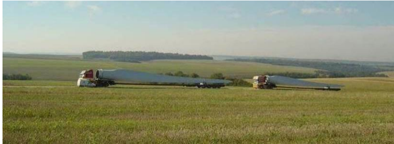
Figure 16 : Exemple de transport de pale par camion
